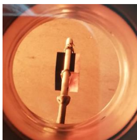
Рисунок 2— Вольфрамовый макет с наноструктурированным пухом на поверхности после испытаний гелиевой плазмой в течение 6 часов 20 минут
