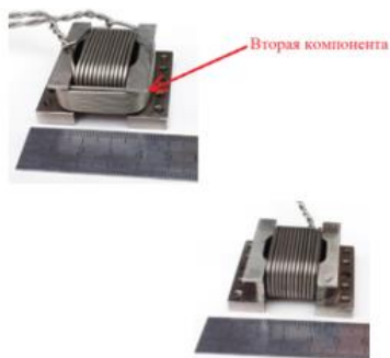
Рис.2. Фото локальных магнитных зондов (кирскабель) Т-15МД.
