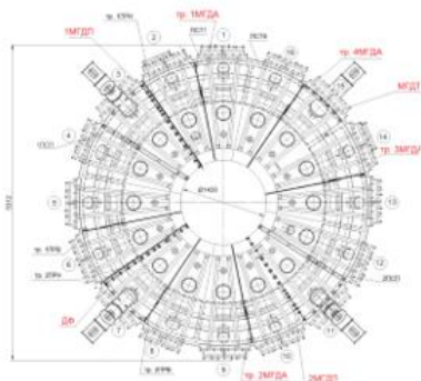
Рис.1. Схема э/м диагностики Т-15МД.
